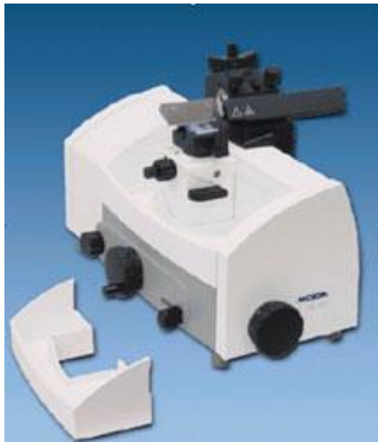
Рис. 3. Санный микротом MICROM HM 400
